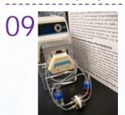
團隊研發了一種高能量新型鋅-碘溴液流電池,刷新 了目前水系液流電池能量密度的紀錄(101 Wh L-1)。
